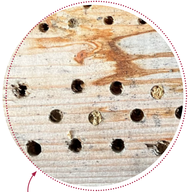
Falsch: Die Löcher dieser Nisthilfe aus Weichholz sind rissig und bilden innen Fasern aus, die für Insekten gefährlich werden können. Daher bleiben solche Röhren leer und die Mühe des Bauens war vergebens!
